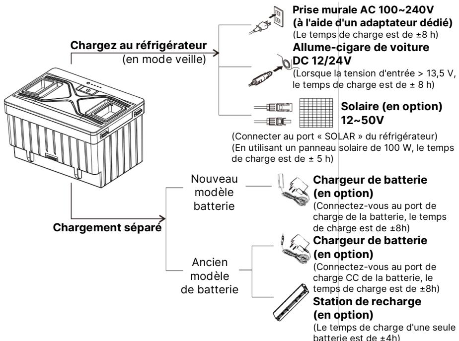
**Remarque :** il est conseillé d'éteindre le réfrigérateur lors du chargement de la batterie (l'alimentation électrique peut principalement alimenter le compresseur lorsque le réfrigérateur fonctionne).
