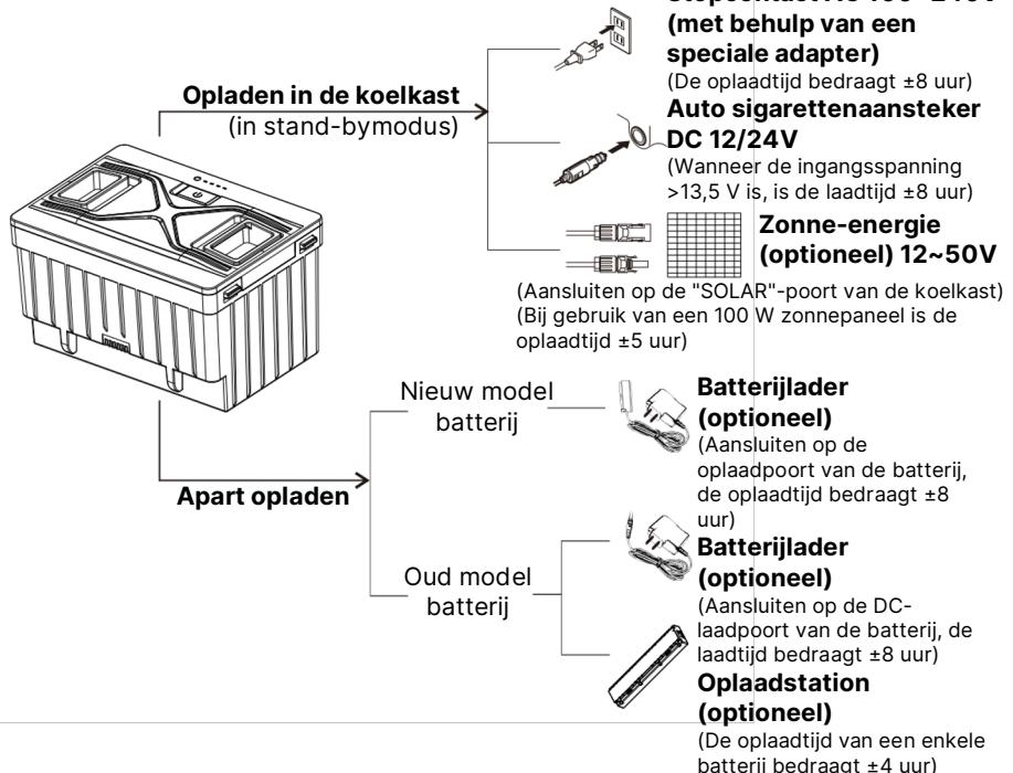
**Opmerking:** Het is aan te raden om de koelkast uit te schakelen wanneer je de batterij oplaat (de stroomvoorziening kan voornamelijk de compressor van stroom voorzien wanneer de koelkast draait).
