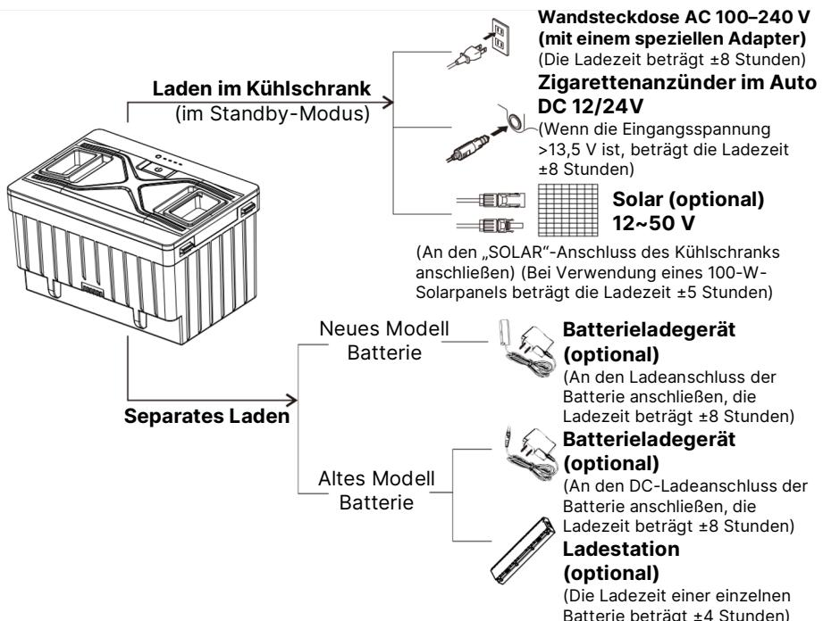
**Hinweis:** Es wird empfohlen, den Kühlschrank auszuschalten, wenn die Batterie geladen wird (die Stromversorgung kann hauptsächlich den Kompressor mit Strom versorgen, wenn der Kühlschrank läuft).
